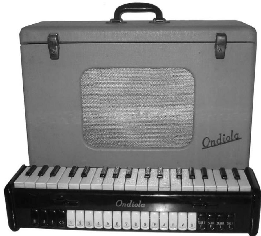
un sub-oscillatore (divisore di ottava) che enfatizza le frequenze basse. La forma d'onda risultante è fatta passare attraverso una serie di filtri analogici (circuiti che attenuano o amplificano una certa area di frequenze all'interno dello spettro del suono) ed è controllata dall'esecutore tramite una serie di interruttori posti sul fronte della tastiera.
